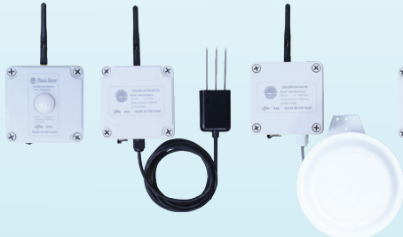
Cảm biến ánh sáng, nhiệt độ, độ ẩm không khí, CO 2 , Ec, nhiệt độ, độ ẩm đất, pH đất
